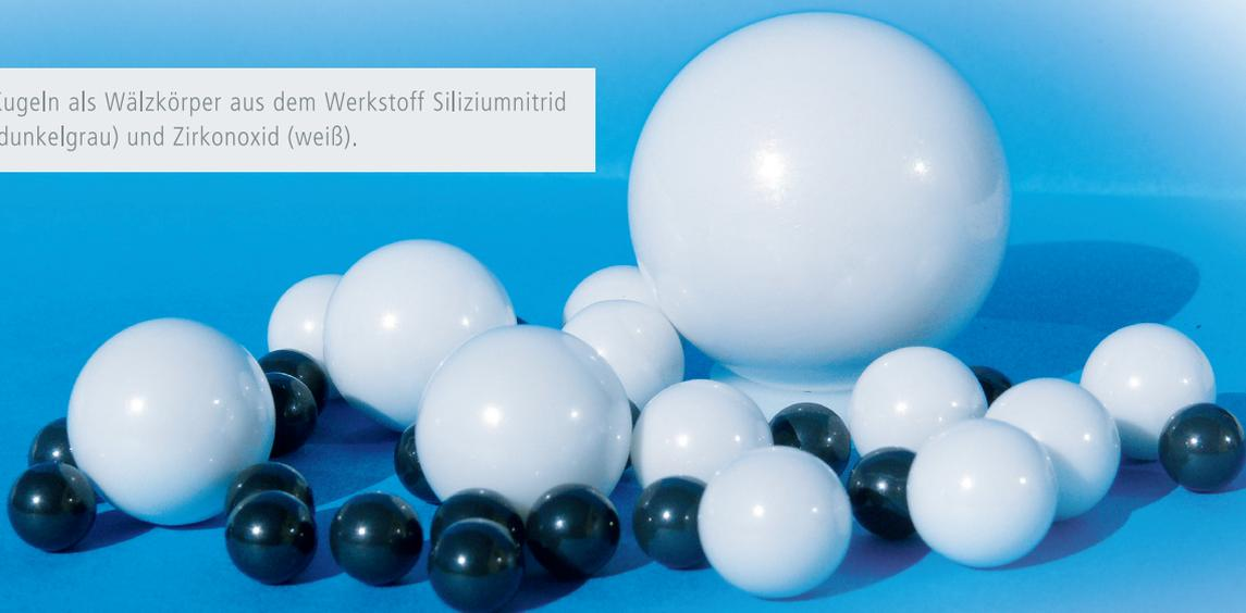
Die im Hybridkugellager geringere Reibung hat eine geringere Wärmeentwicklung zur Folge. Da die erreichbaren Drehzahlen vor allem von den thermischen Bedingungen im Lager abhängen, lassen sich je nach Anwendung Drehzahlsteigerungen bis zu 30% gegenüber Lagern mit Stahl-Kugeln realisieren. Hybridlager können somit zur Leistungssteigerung von Maschinen und Anlagen beitragen.
